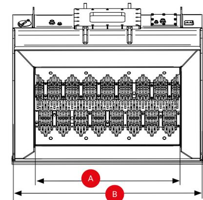
\* Trenn- und Siebschaufel mit festen Wellen, Werkzeuge müssen gewechselt werden, um die Größe zu ändern
