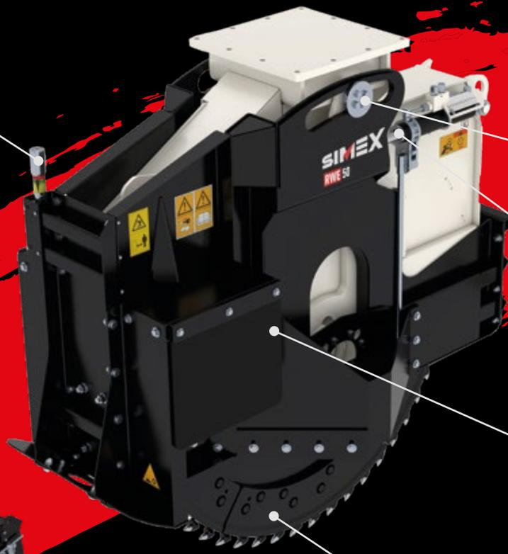
Das selbstnivellierende System garantiert unter jeder Bedingung eine stets konstante Frästiefe, unabhängig vom Bodenprofil und der Lage des Anbaugeräts zum Trägergerät.
