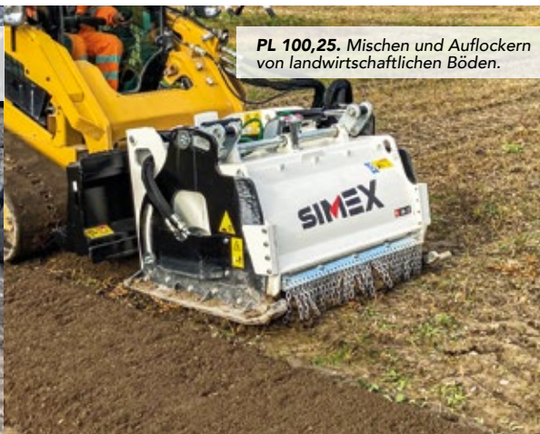
PL 100,25. Bodenstabilisierung mit Kalk zur strukturellen Konsolidierung der Straße.
