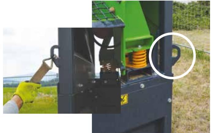
Beispiel der richtigen Befestigung der Siebmaschine siehe nachstehendes Bild:
