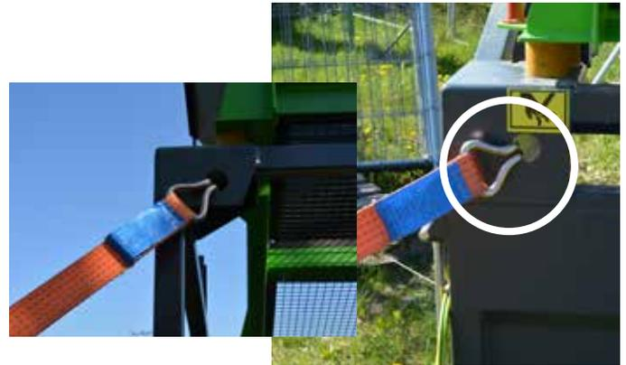
Beispiel der richtigen Befestigung der Siebmaschine siehe nachstehendes Bild:
